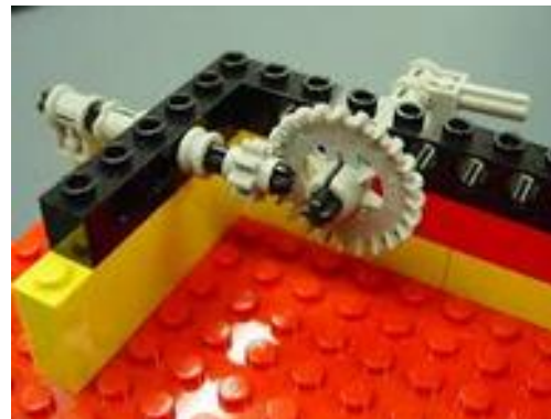
Γρανάζι κορώνα 24 δοντιών (περίπου όπως τα κωνικά γρανάζια δεξιά)
